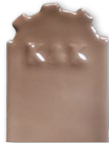
L 307, 5% Lososová, lesklá, polokrycí, bez haarrissu
