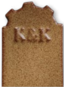
MX 0, 10% Brown sugar, matná, efektní, vykreslující, haarriss není vidět
