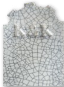
KGG 44, 30% Krakele, efektní, pololesklá, polokrycí, viditelný haarriss
