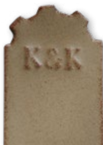
E 125, 10% Oříšek, matná, efektní, vykresluje hrany, haarriss není vidět
