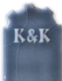
MX 194, 5% Šedá vodovka, průhledná, lesklá, viditelný haarriss
