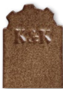
MX 1, 10% Karamela, pololesklá, krycí, efektní, vykresluje hrany, haarriss není vidět
