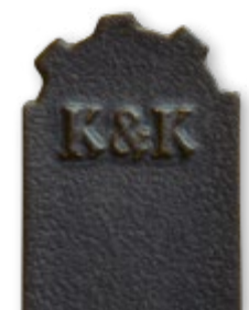
MX 180, 10% Hnědá kůže, efektní, krycí, haarriss není vidět
