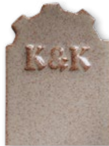
E 77, 10% Vonnegut, efektní, polo- lesklá, vykresluje hrany, haarriss není vidět
